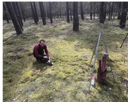
Abbildung 3: Feldmessungen (Wasserproben & Druckspiegel & Leitfähigkeit Messungen)
